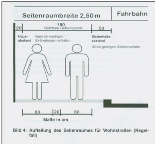
Abb. 37: Regelmaß von Fußgängerkehrsanlagen nach EFA 2002
