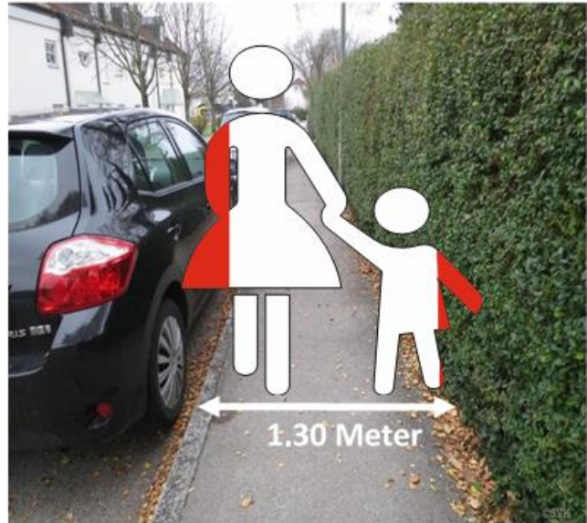
Abb. 37: Regelmaß von Fußgängerkehrsanlagen nach EFA 2002
